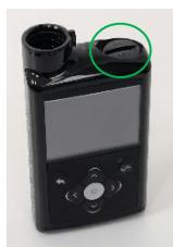
Poklopac baterije na pumpi
