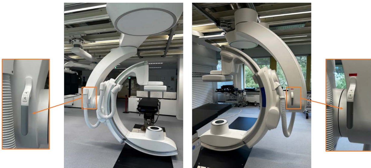
Slika 3: Ručka s kontrolama kočnica na obje strane postolja FlexArm
