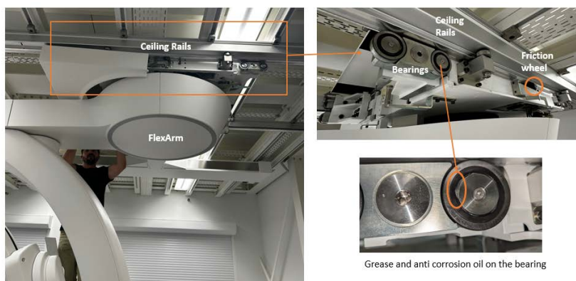
Slika 2: pregled elemenata postolja FlexArm i identifikacija problema
