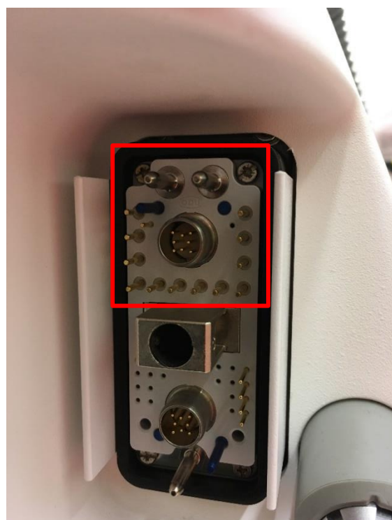
slika 3: primjer područja s kontaktima priključka X10 koje se ne smije doticati
