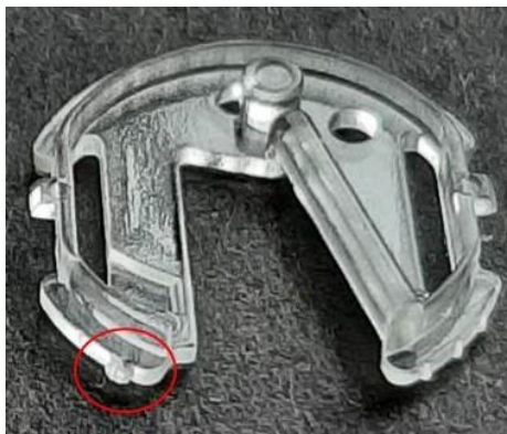
Previše materijala (crveni krug)
