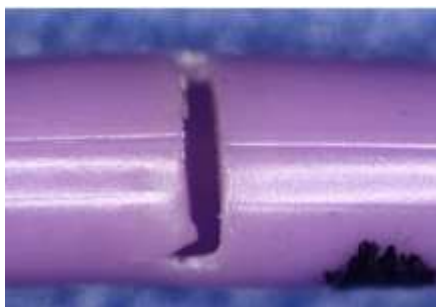
Slika 1: Primjer poprečne/obodne pukotine u cijevi katetera
